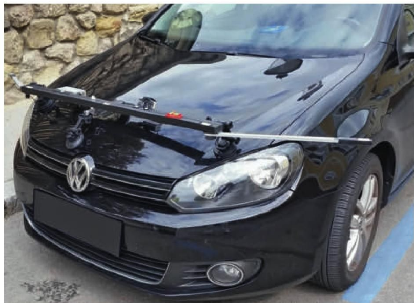
Der Messbalken auf dem Fahrzeug misst und speichert die wesentlichen Daten des gesamten Lichtnetzes.
