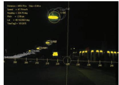
Die LimeCam Messung erfolgt bei Dunkelheit mit Geschwindigkeiten von bis zu 80 km/h. Die Messung erfolgt mit dem normalen Verkehrsfluss, ein Absperren der Verkehrsflächen ist nicht nötig.
