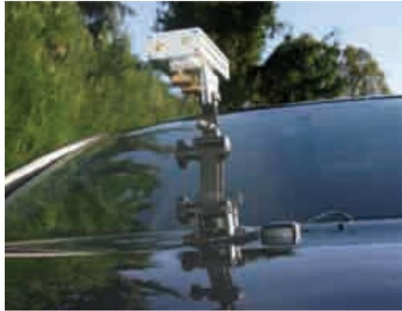
*Mittels Saugstandfuß kann das Lichtmessgerät sicher auf der Motorhaube eines Autos befestigt werden. So können die zu vermessenden Straßen einfach und bequem abgefahren werden.*
